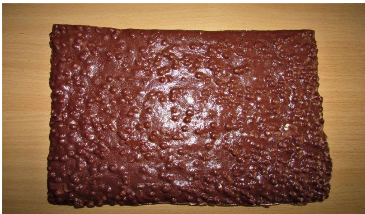
Рис. 5.69. Зовнішній вигляд універсальних електромагнітних та шумозахисних екранів: а) на основі пінолатексу; б) на основі пінолатексу та пінополістиролу
