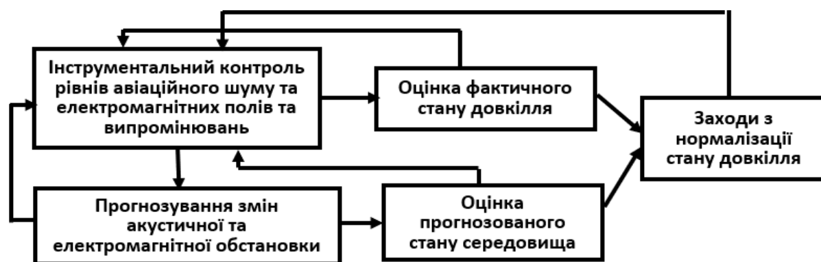
Рис. 5.57. Загальна схема автоматизованої системи моніторингу електромагнітної обстановки
